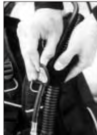
(Abb. 2) Inflator und Inflatorschlauch mit dem Klettband sichern.
