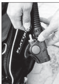
(Рис.1) Подключите шланг низкого давления к ниппелю на инфляторе.
