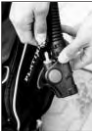
(Abb. 1) Anschließen des Tiefdruck-Inflatorschlauchs am Inflatorstutzen.
